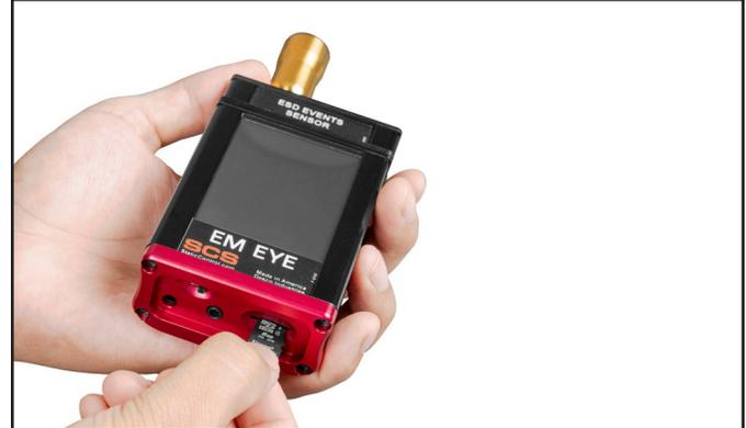
Abbildung 3. Einsetzen einer microSD-Karte
