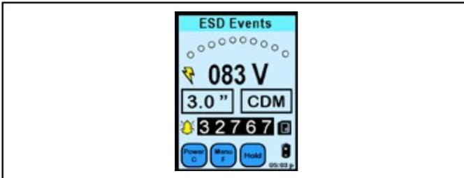
Abbildung 17. Anzeige der ESD-Ereignisspannung
