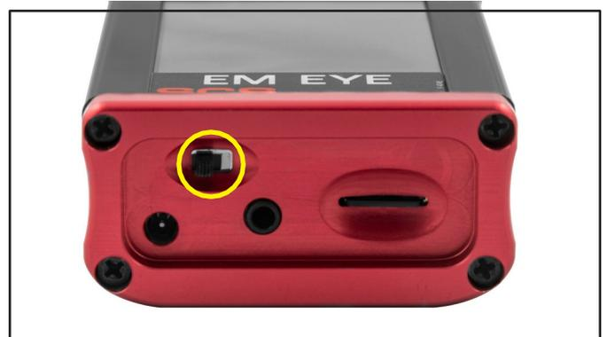
*Abbildung 7. Lage des Netzschalters an der Unterseite des EM Eye Meters*
