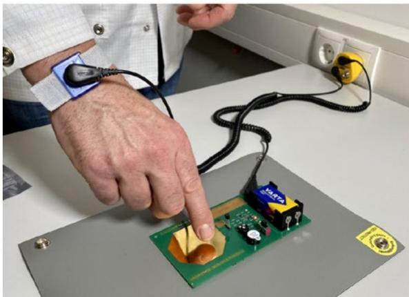
Dadurch wird die elektrostatische Aufladung der Person über den FET gegenüber der Massefläche auf der Unterseite des ESD-Boards bzw. gegen die angeschlossene Systemerde entladen.
