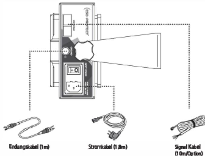
Achten Sie darauf, das Gehäuse der Serie 50B-S zu erden, um die stabile Leistung des Produkts zu gewährleisten und einen elektrischen Schlag zu vermeiden.
