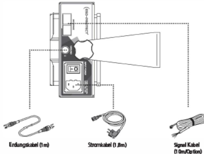
Achten Sie darauf, das Gehäuse der Serie 50B-S zu erden, um die stabile Leistung des Produkts zu gewährleisten und einen elektrischen Schlag zu vermeiden.
